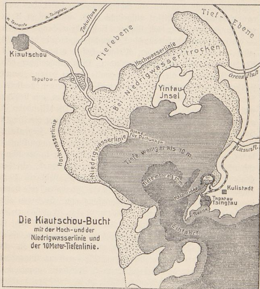
Fig. 22. Die Kiautschou-Bucht mit der Hoch- und der Niedrigwasserlinie und der 10 Meter-Tiefenlinie.
