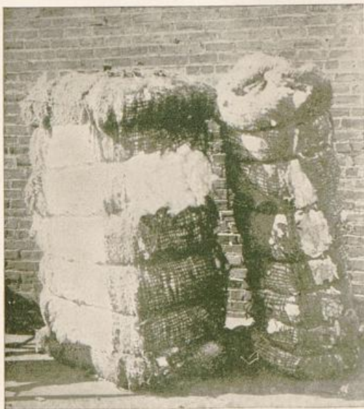
Ein lose verpackter und ein zusammengepreßter Ballen. Ein gewöhnlicher Kastenwagen faßt ungefähr 50 zusammengepreßte oder 25 lose verpackte Ballen.
