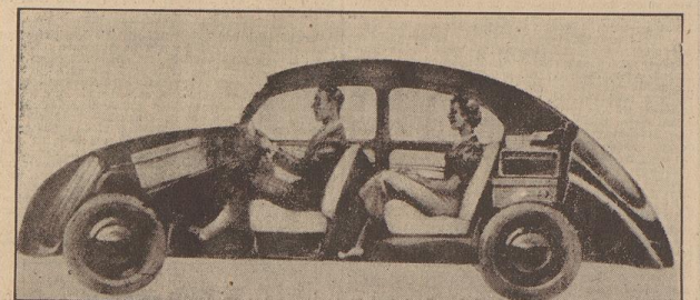
Unser Bild, das dem Prospekt über den Volkswagen entnommen ist, beweist die bequeme Geräumigkeit des KdF-Wagens und zeigt die Unterbringung von Tank, Koffer- und Reserverad.
