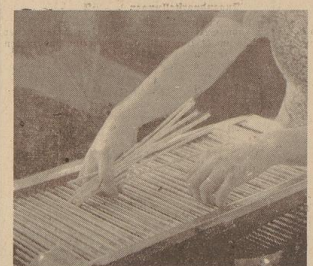
Diese Maschine umschließt die einzelnen Halme mit einer bereits im gleichen Arbeitsgang bedruckten Zigarettenpapierhülle.
