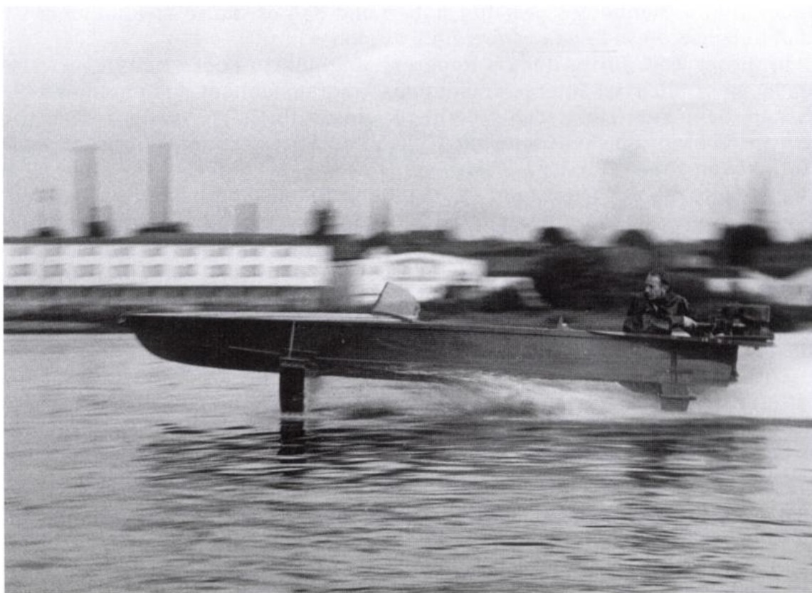
Abb. 1: Das Focke-Schaper-Tragflächenboot, 1951 auf der Lesum vor Vegesack, im Hintergrund die Vegesacker Anlagen der Lürssen-Werft. (Foto: Historisches Archiv Fr. Lürssen Werft, Bremen-Vegesack)
