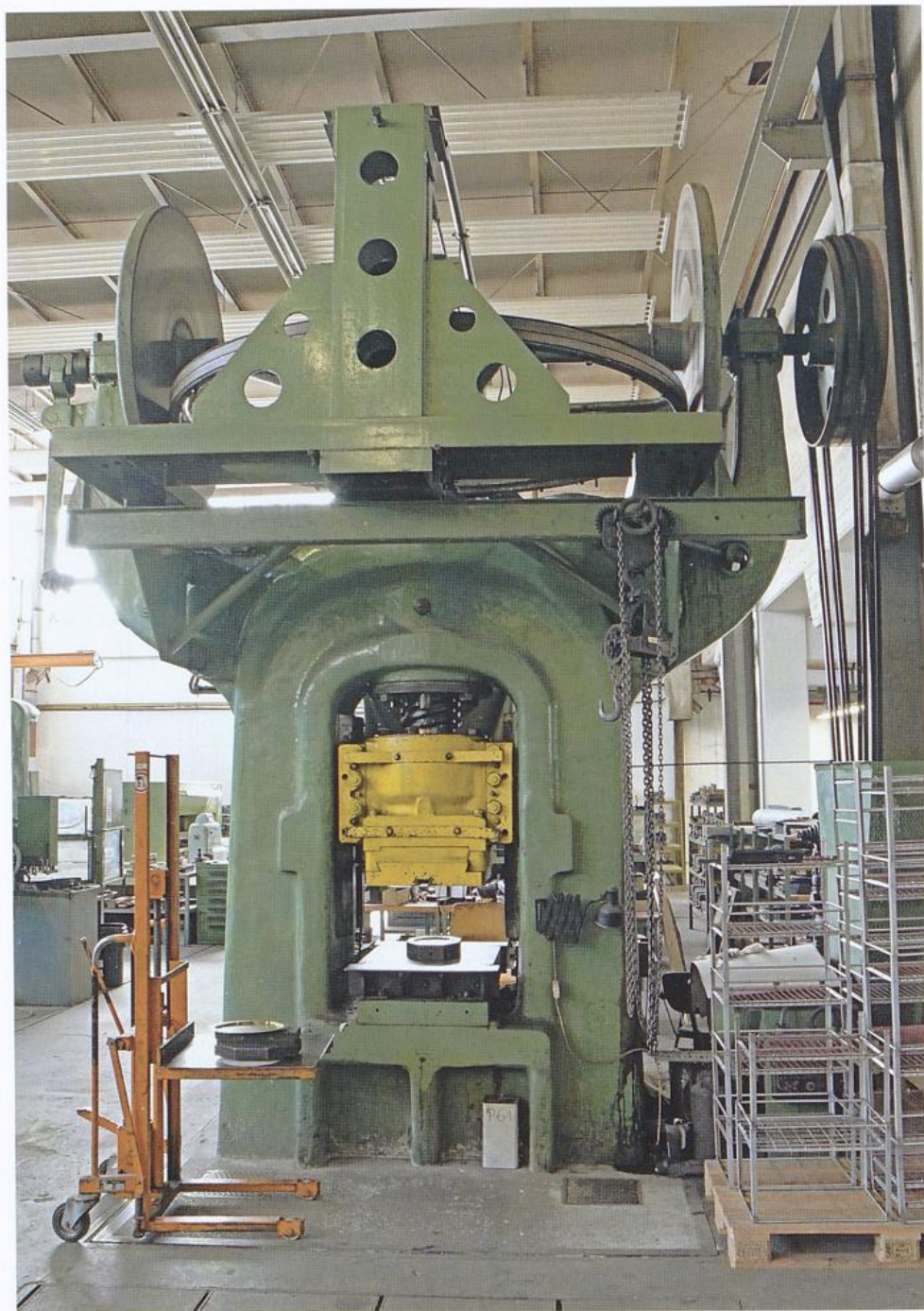
Silberwarenfabrik Wilkens, denkmalgeschützte Friktionsspindelpresse der Firma Weingarten mit Baujahr 1918, 2020
