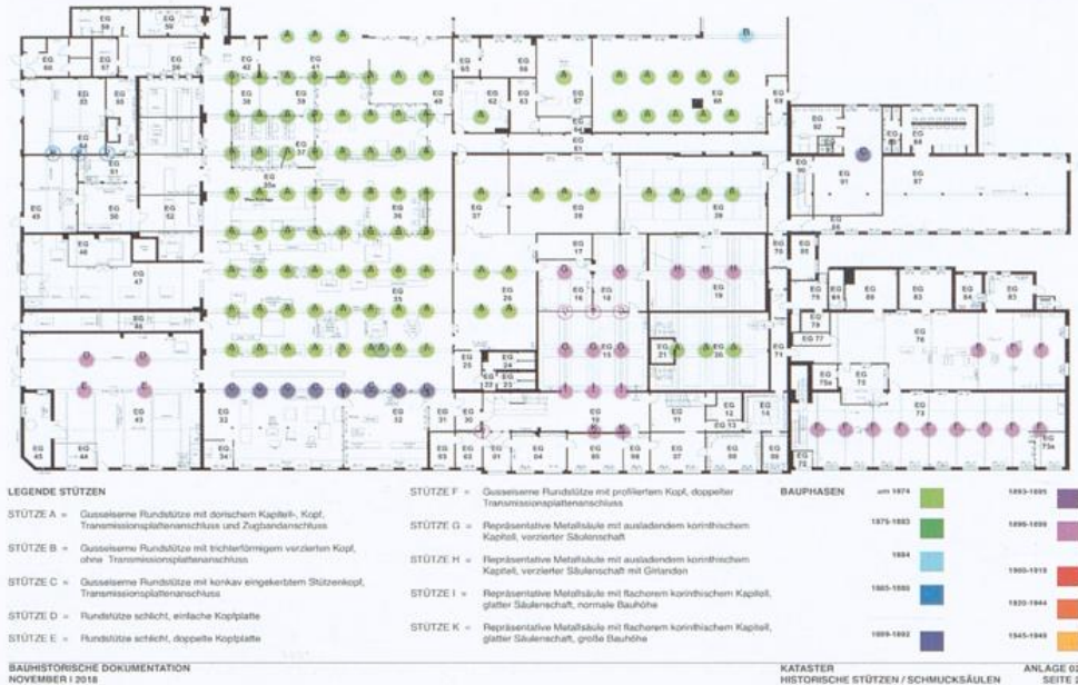
Abb. 3: Kartierung der erhaltenen gußeisernen Stützen in der Silberwarenfabrik Koch & Bergfeld, nach Bauphasen
