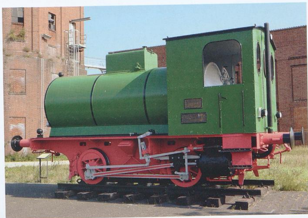
Dampfspeicherlokomotive der ehemaligen Werksbahn der Bremer Wollkämmerei
