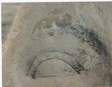
Verwitterungskrusten auf Elm-Kalkstein, Detail des originalen Roland-Kopfes
