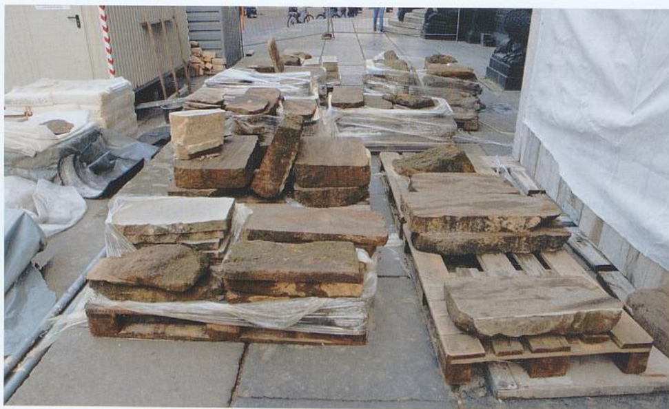
Sandsteinmaterial für Reparaturen aus dem Depot der Denkmalpflege
