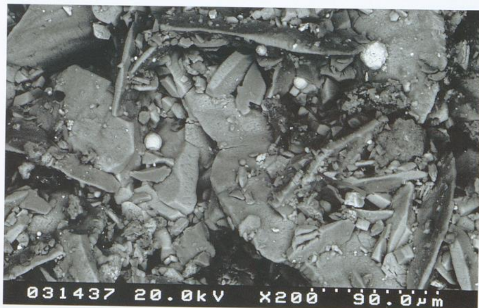
Abb. 3 a–e: Mikroskopische Analysen einer abgeplatzten Sandsteinscholle. Abb. 3 a: REM-Aufnahme der verschwärzten Oberfläche
