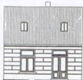
Borchersweg 1 kleinster Typ des Bremer Hauses eingeschossig ohne Souterrain Dachgeschoss ursprünglich nicht ausgebaut Hausbreite: 6,80 m Haustiefe: 5,60 m
