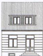
Rutenstraße 18 eingeschossiges kleines Bremer Haus mit Souterrain mit ausgebautem Dachgeschoss Hausbreite: 6,75 m Haustiefe: 8,30 m
