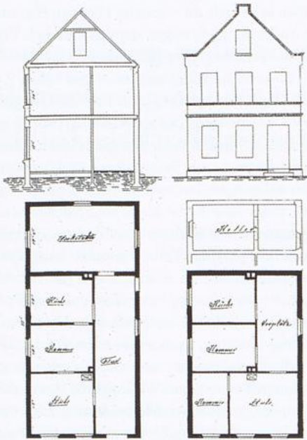
Abb. 3: Grundriss, Querschnitt und Ansicht eines typischen »Leher Hauses«, 1874
